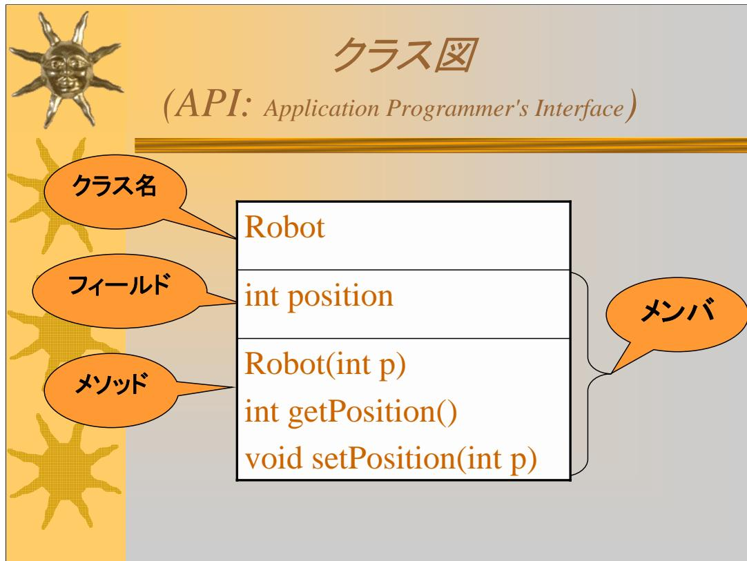
いつもクラスを定義したJavaのソースコードを見るのは大変なので、設計内容の概略をこのような**クラス図**として図式化することが多い。
