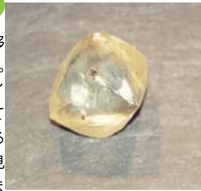
工業用ダイヤモンド 圧縮のときに空気中の窒素が 混入し黄色くなる。
