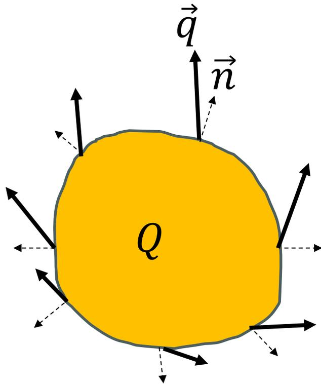
左図のような場合、この物体表面から漏れていく総熱量は以下のように $(\vec{q} \cdot \vec{n})$ の表面積分で記述される。
