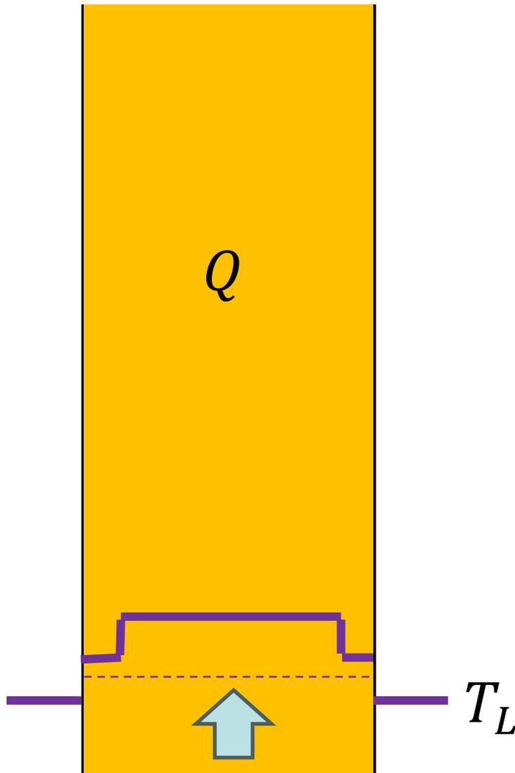
物体の表面付近では、温度上昇により対流熱伝達がさらに促進され、温度上昇はさらに抑えられる。
