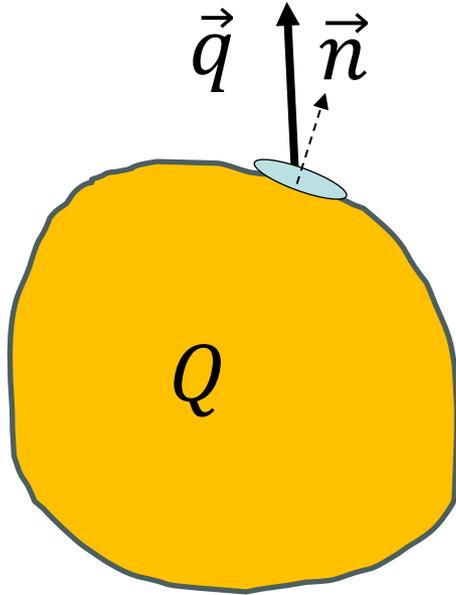
厳密には、熱流束はベクトル量であり、「熱流束ベクトルに対して直交する平面上の」単位面積あたりの通過熱量を示す。
