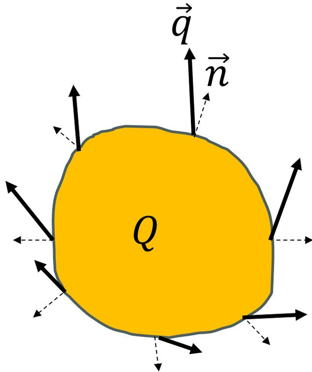
表面からの熱の漏れの総量  $\int -\lambda \nabla^2 T dV$  と発熱量  $\int Q dV$  が釣り合っていないときには、その差分だけ、その位置での媒質の温度が変化する。
