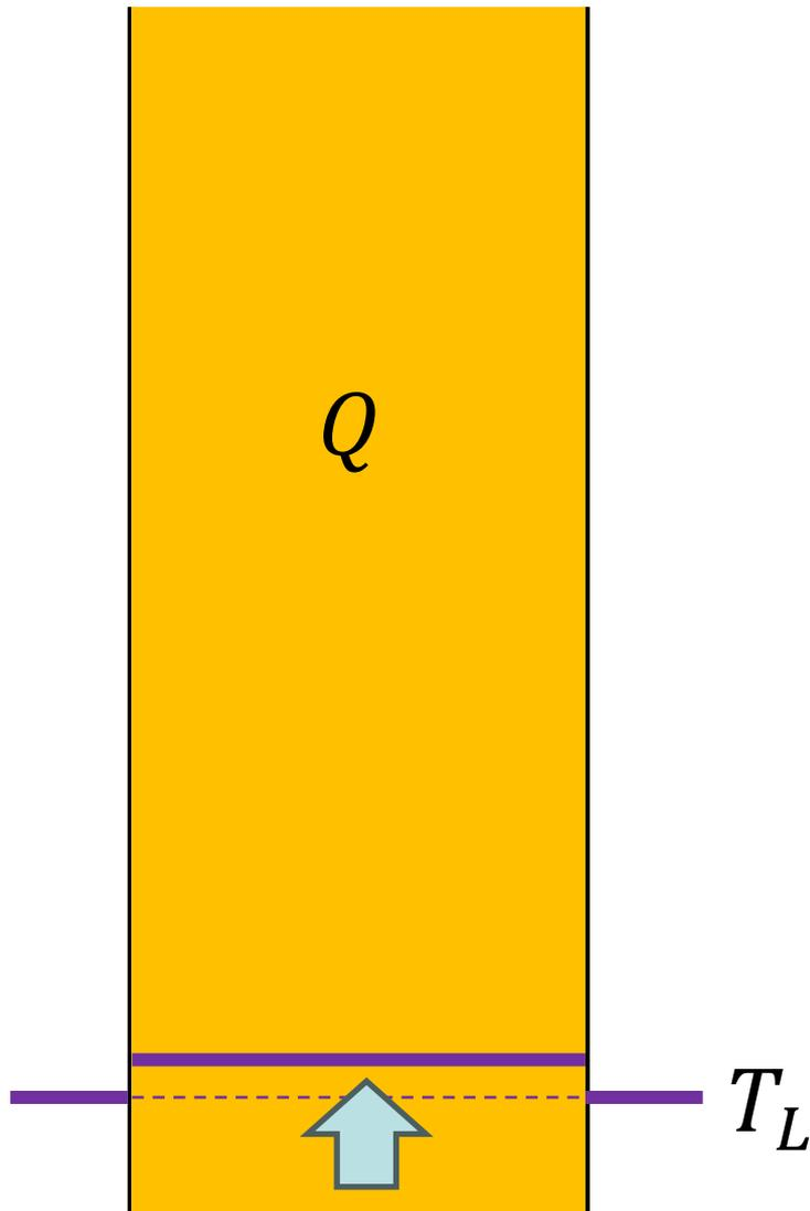
すると、物体表面と外側流体との間に温度差が生じるため、対流熱伝達による熱の移動が発生し、表面付近での物質の温度上昇は抑えられる。
