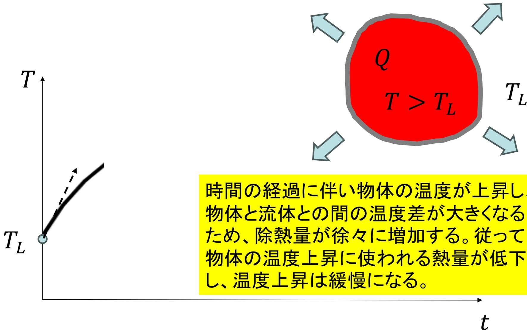
時間の経過に伴い物体の温度が上昇し、物体と流体との間の温度差が大きくなるため、除熱量が徐々に増加する。従って、物体の温度上昇に使われる熱量が低下し、温度上昇は緩慢になる。
