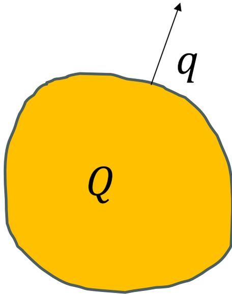
微小体積の、ある表面位置における熱流束 $q$ は、その位置での微小面積 $\Delta A$ を(単位時間に)通過する熱量が $\Delta Q$ であるとき、
