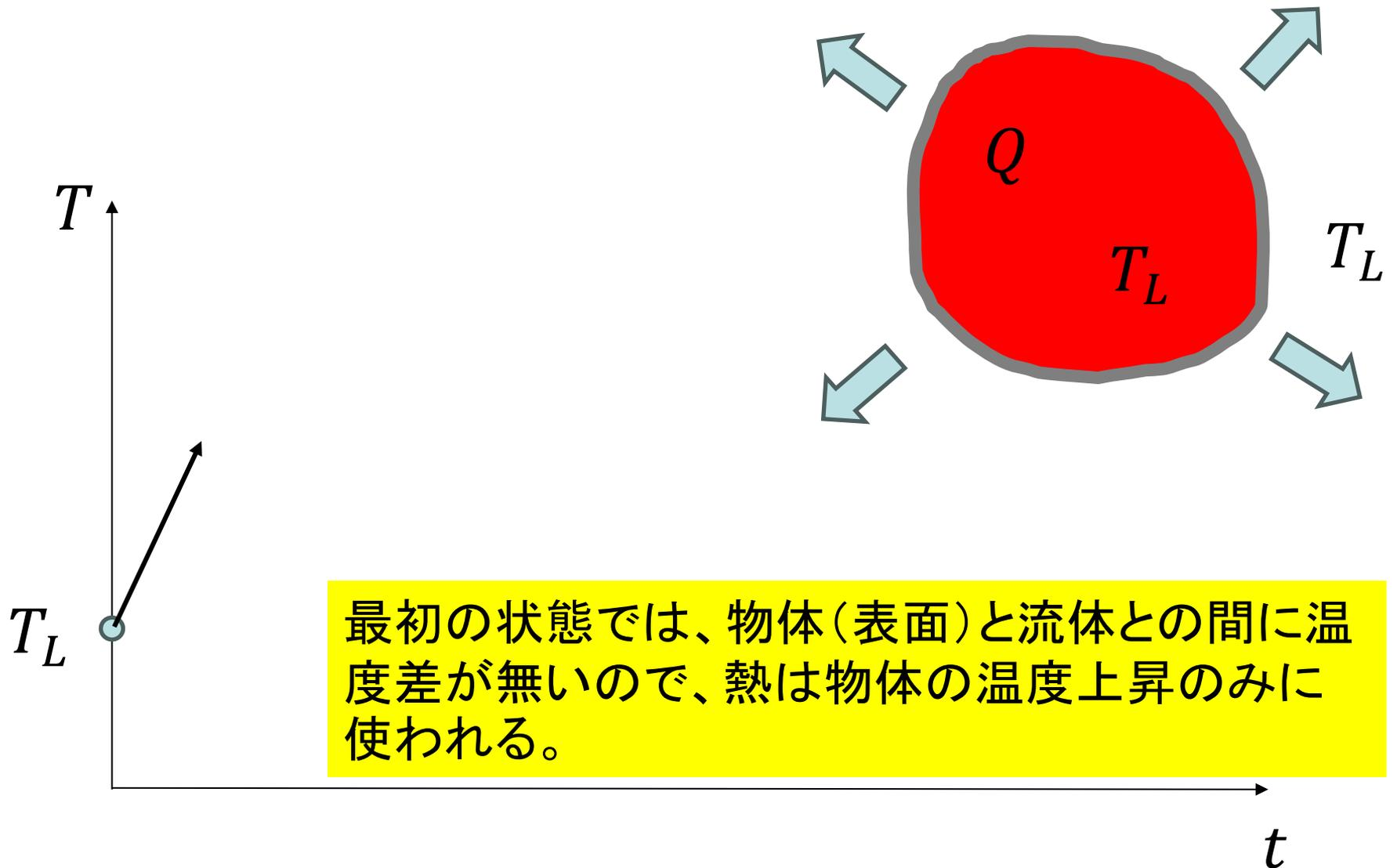
最初の状態では、物体(表面)と流体との間に温度差が無いので、熱は物体の温度上昇のみに使われる。
