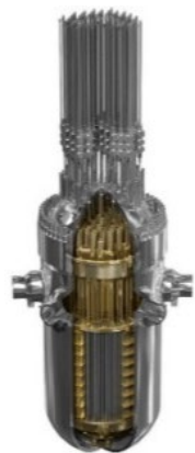
原子炉容器/ 炉内構造物
