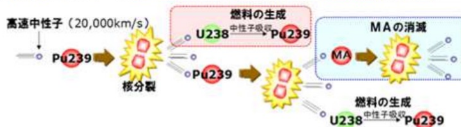
高速炉におけるエネルギーの発生と放射性廃棄物の減容化・有害度低減の仕組み
